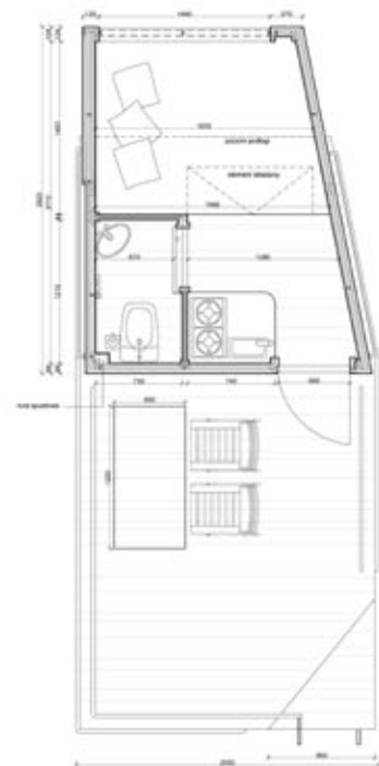
Rzut pojedynczego modułu domku letniskowego. Skala 1:25.
