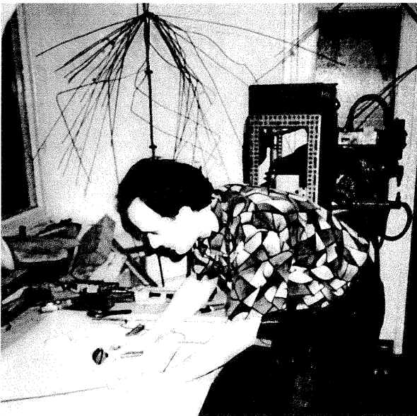
FOT.2 Wyginane ręcznie poszczególne pręty siatki. /W tle widoczne gotowe wygięte pręty/.
